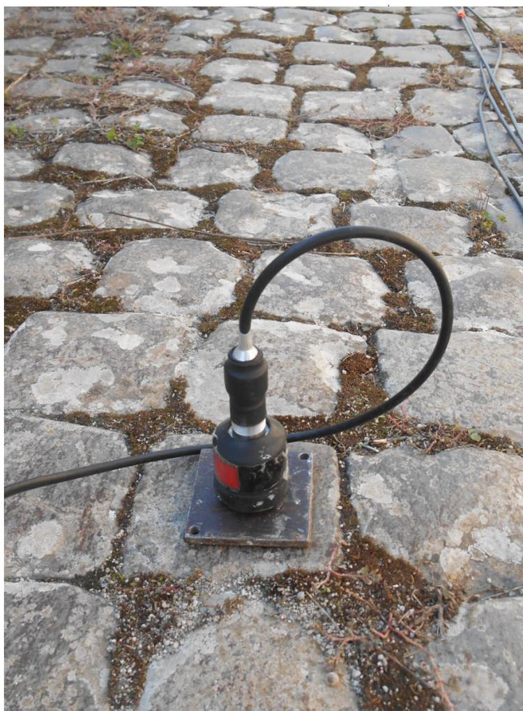
li test statici, consentendo di estendere il dato diretto ad un maggior numero di elementi. In una scuola, ad esempio, ESSEBI ha effettuato due prove statiche e sette dinamiche. Si è potuto estendere il risultato delle prove statiche per correlazione con le grandezze dinamiche misurate tramite Impact Testing, ottenendo una più estesa conoscenza delle condizioni strutturali dei solai presenti.
