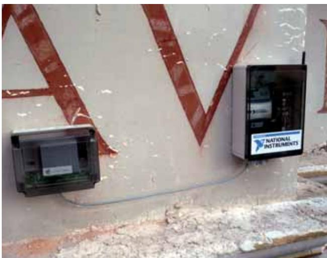
**Modulo NI WSN collegato a un trasduttore via cavo**
